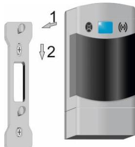
Рисунок 3 – Установка сигнализатора
