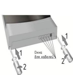
Рисунок 2 – Снятие крышки клеммного отсека
